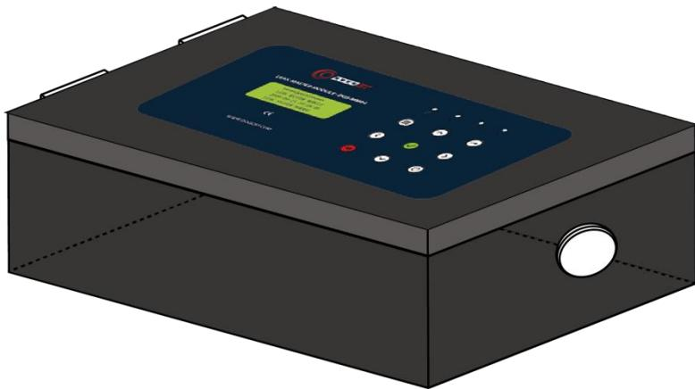
DGS-MM01 主控制器可以用一种独特的方式对最多达到 32 台子检测控制器进行控制，也就是说它可以同时接受最多 32 个不同地址的信息采集。当其与子控制器连接后，就可以监测到子控制器上的漏液和断线报警信息，并通过 Relay 及以太网接口将数据信号上传给平台系统。主控制器本身可保存最多 999 条报警记录信息。
